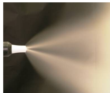
слишком много воздуха для продувки электродов
