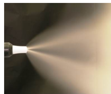
слишком много продувочного воздуха для электродов
